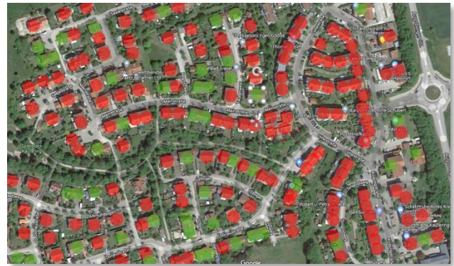
Beispiel Kaufering Nord: Belegung solartauglicher Dachflächen (rot = Potential vorhanden, grün = bereits belegt)
